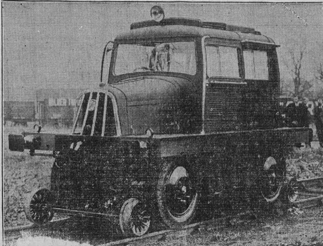
Vozilo, ki ga kaže gornja slika, je imenovano "loco-traulier", in je zelo pripravno. Kjer je lepa cesta, se z njim vozi kakor z avtomobilom. Slabih cest pa se lahko izogne s tem, da jo udari kar po železniški progi, za kar ima posebna kolesa.
