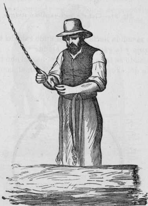
Fig. 83.—Acto de sujetar el obrero un nudo del ramal al gancho de la aguja.
