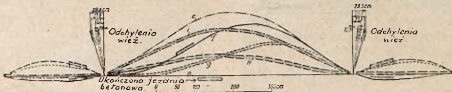
Rys. 51. Linje ugięcia belek sztywności podczas montażu
