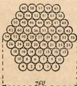
Rys. 14. Przekrój liny wiszącej z drutu stalowego na siodelku i przekroje prętów zakotwienia.
