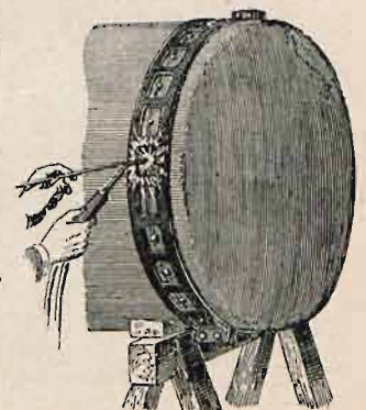
Rys. 2. Opaska do zczepiania dna do bębna.
