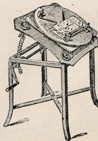
Rys. 1 Stół do spawania z podnoszonym i obrotowym blatem.
