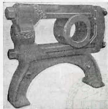
Rys. 2. Rama żeliwna naprawiona zapomocą lutospawania.
