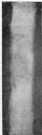
Rys. 15. Negatyw spoiny na V poprawnie wykonanej.
