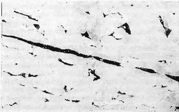
Ryc. 25. 100× traw. kw. azot. Struktura mat. przegrzanego; żużel.
