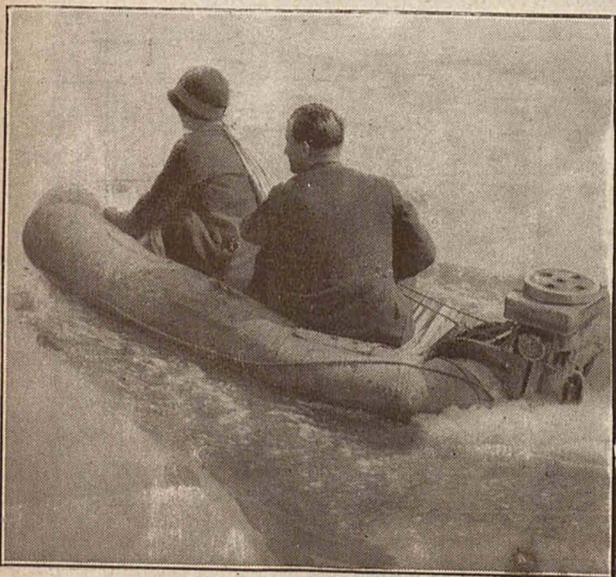
W Ameryce używa się obecnie oryginalnych łódek motorowych, złożonych z gumowej nadmuchanej łódki i małego motoru 2 HP.
