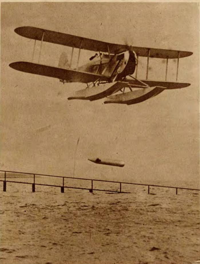
Pierwszy torpedowiec powietrzny. Na zdjęciu widzimy torpedę rzuconą przez hydroplan, której siła wystarcza do wysadzenia w powietrze największego okrętu wojennego.
