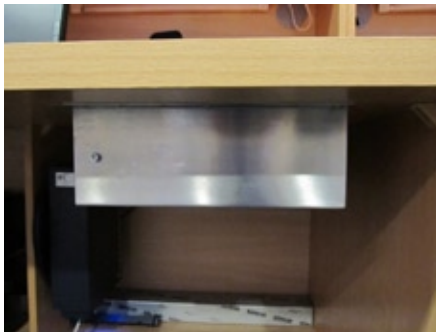
Czytnik RFID z anteną podblatową wraz z miejscem przygotowanym na położenie książek
