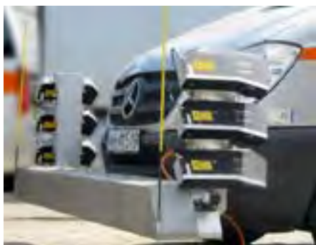
Profilograf laserowy (SDPD) – urządzenie służące do trójwymiarowego skanowania powierzchni drogi.
