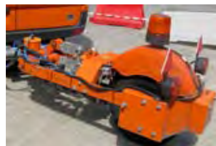
SRT-3 Polska konstrukcja przyczepki mierzącej właściwości przeciwpoślizgowe nawierzchni.
