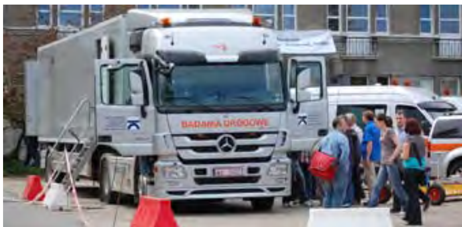
Traffic Speed Deflectometer TSD, urządzenie do pomiaru nośności nawierzchni drogowej
