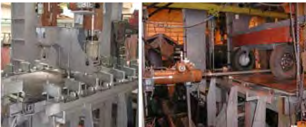
Modele w trakcie badań zmęczeniowych: a) obciążenie punktowe, b) rampa pojazdowca pod obciążeniem tocznym
