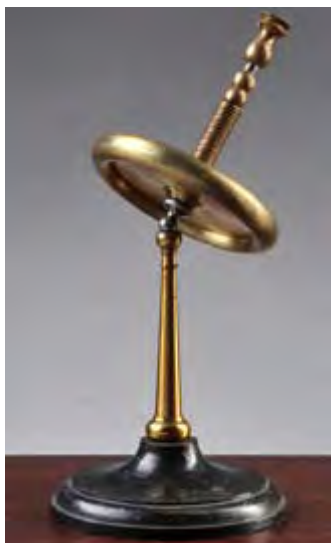
Rys. 7. Bąk wykonujący ruch precesyjny umieszczony na smukłej podstawie.
