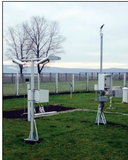
Rys. 12.1. Automatyczna stacja meteorologiczna MAWS 301 (Skapski, 2006)
