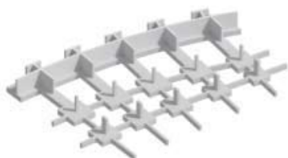
Fragment pierścienia fundamentowego oraz stóp fundamentowych
