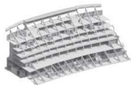
Fragment konstrukcji wsporczej trybuny zachodniej
