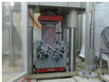
Rys. 13. Stanowisko badawcze nośności węzła podporowego
