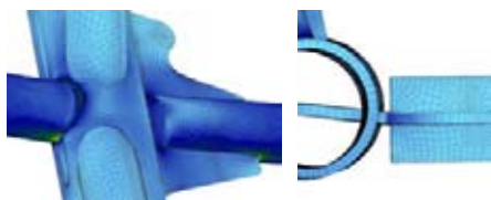
Rys. 8. Wizualizacja węzła z pokazaną imperfekcją geometryczną blachy węzłowej
