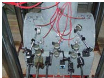
Rys. 13. Stanowisko badawcze nośności węzła podporowego
