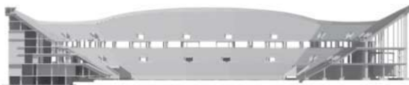
Przekrój przez trybuny zachodnią (VIP) i wschodnią z widokiem na trybunę północną
