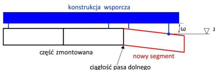
Rys. 5.17. Ustawienie nowego segmentu
