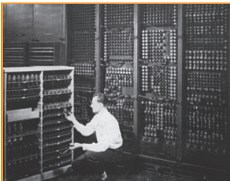
Rys. 1. ENIAC. Pierwszy wielozadaniowy, całkowicie elektroniczny komputer do celów obliczeniowych, zbudowany na lampach elektronowych
