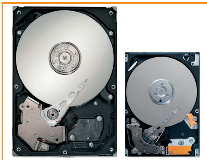
Rys. 9. Dysk twardy 3,5" stosowany w komputerach stacjonarnych (po lewej) i 2,5" stosowany w komputerach przenośnych (po prawej)
