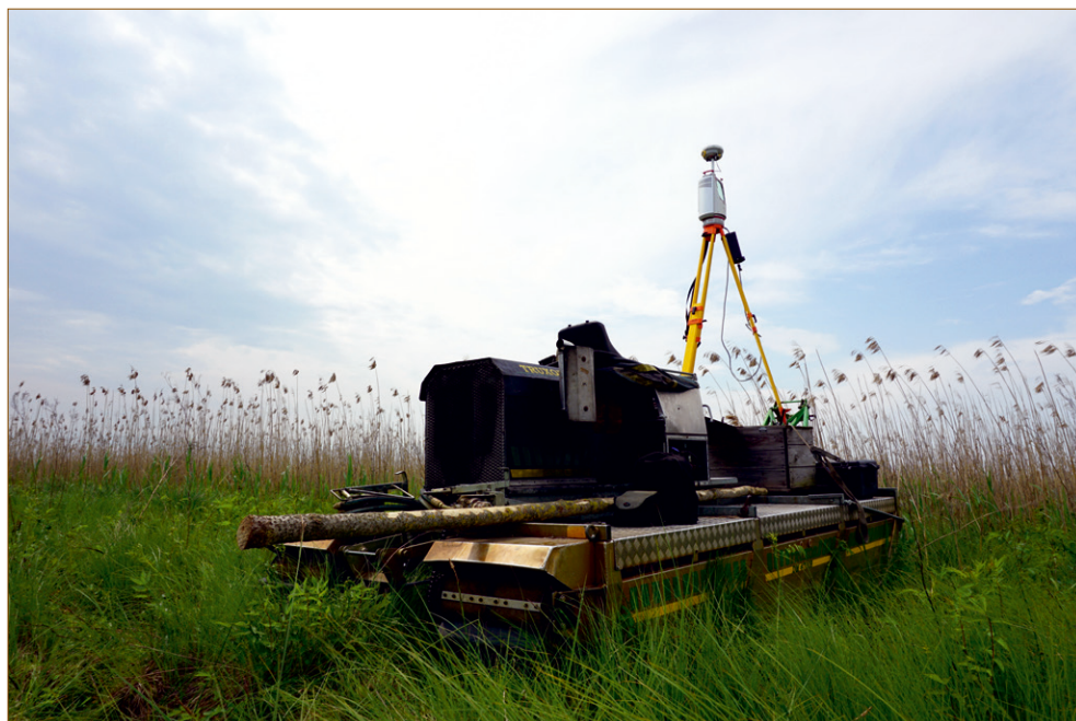
Ryc. 5. Stanowisko pomiarowe TLS zamontowane na ratraku przystosowanym do koszenia traw. Fig. 5. A TLS measuring station mounted on top of the grooming machine.
