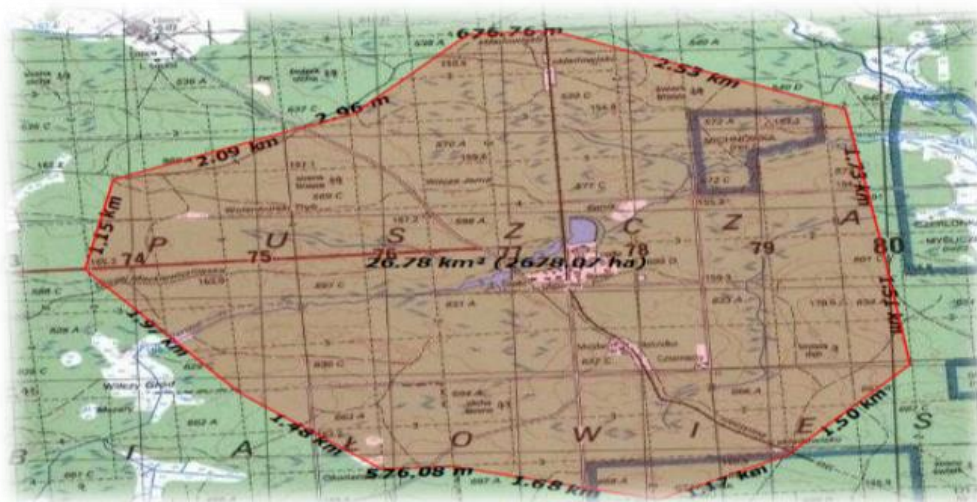
Rys. 5. Wyznaczona zlewnia zbiornika Topiło
