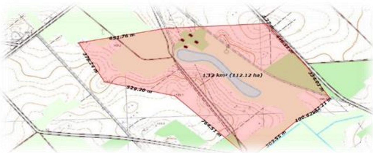
Rys. 1. Wyznaczona zlewnia zbiornika Bachmaty
