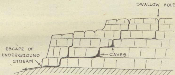
FIG. 28.—UNDERGROUND DRAINAGE IN JOINTED LIMESTONE
