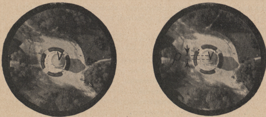
Fig. 91. Obraz stereoskopowy, widziany w przyrządzie z zaznaczoną paralaksą pionową.
