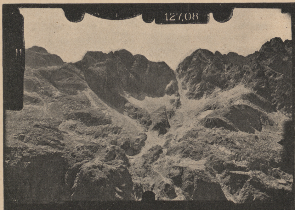
Fig. 36. Zdjęcie fotograficzne wykonane kamerą firmy Zeissa z podstawy pod Granatami w Tatrach na Zawrat. 127,08 oznacza ogniskową, I serję, 11 liczbę porządkową zdjęcia.
