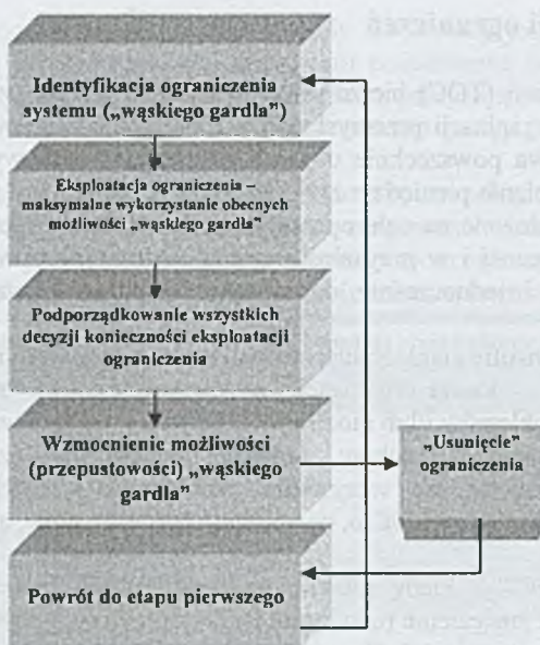
Rys. 10. Procedura postępowania przy wdrażaniu TOC
