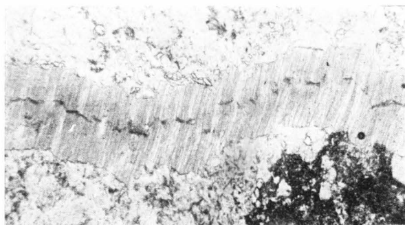
Fig. 4. — Filonaș de crisotil în skarne magneziene hidrotermalizate. În masa skarnelor se observă relice de forsterit transformate în antigorit; N+; \times 40 .
