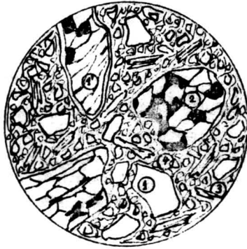
Fig. 9 - Căramidă: 1-cuarț, 1' - cuarț cu coroană de sticlă; 2-cuarțit; 3-biotit; 4-matrice N +, ~ 40 x
