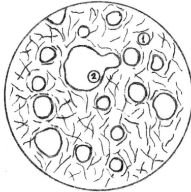
Fig. 66 - Sticlă cu incluziuni gazoase: 1- masa sticloasă, 2- bule de gaze ; N II , \sim 100 \times
