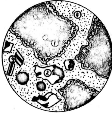
Fig. 62 - Beton ușor cu agregate de tuf vulcanic și cu nisip: 1- fragment de tuf cu zonă de reacție cu cimentul; 2-cuarțit, 3-feldspat, 4-ciment; N + , ~ 40 x
