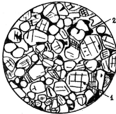
Fig.37 - Refractor magnezitic - 1-cristale izometrice de periclaz cu olivaje după două direcții; 2-fază sticloa- să ce sudează cristalele; N II, ~ 100 x
