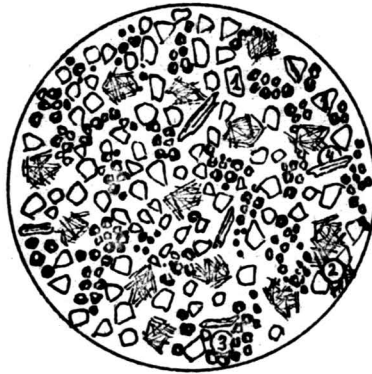
Fig. 20 - Gresie ceramică: 1-cuarț; 2-mullit; 3-spineli; N II, ~ 100 x
