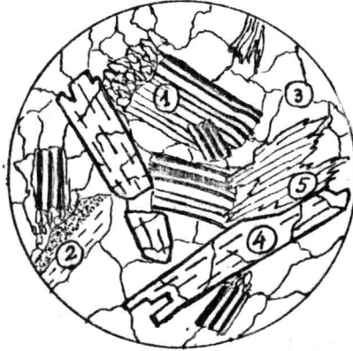
Fig. 86 - Granit de Meri: 1-feldspat plagioclaz, 2-ortoză cu maclă de Karlsbad, 3-cuarț, 4-hornblendă comună, 5-biotit; N +, ~25 x.
