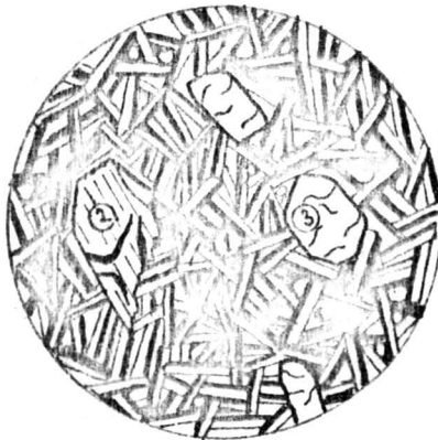
Fig. 90 - Bazalt de Racoș: 1- masa fundamentală din microlite de plagioclaz, cu structură intersertală; 2-fenocristal de augit; 3-fenocristal de olivină; N +, ~ 40 x.
