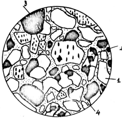
Fig. 91 - Gresie de Urviș; 1-granul de cuarț, 2-granul de cuarțit, 3-fragment de silix 4-ciment argilos de atingere; N +, ~40
