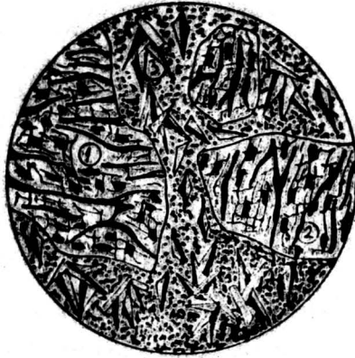
Fig.32 - Căramidă silica cu început de tridimitizare: 1-cuarțite; 2-cristobalit (isotrop) pe fisurile cuarțitului ; 3-cristale de tridimit maclate ; N+, ~ 40 x
