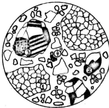
Fig. 61 - Beton cu agregate monoclastice de carieră B 300: 1-calcar recristalizat, 2-cuarțit, 3-leucogranit, 4- ciment N +, ~ 25 x.
