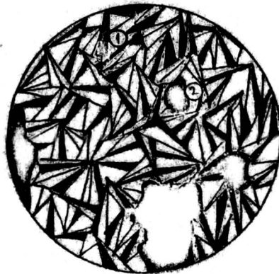
Fig.33 - Căramidă silica complet tridimitizată: 1-cristale de tridimit cu macle în formă de vîrf de lance; 2-pori; N +, ~ 100 x
