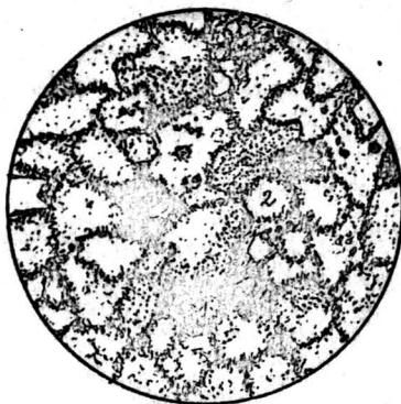
Fig. 22 - Granulit: 1-fragmente de cuarț; 2 - pori, NII, ~400 x.
