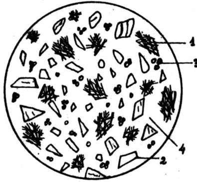
Fig. 24 - Porțelan mullitic: 1-mullit; 2-cuart; 3-spineli; 4-masă sticloasă N II, \sim 100 \times
