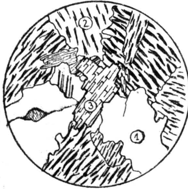
Fig. 85 - Granit de Iacobdeal : 1-cuarț, 2-ortoză perititică , 3-riebeckit; N +, ~40 x
