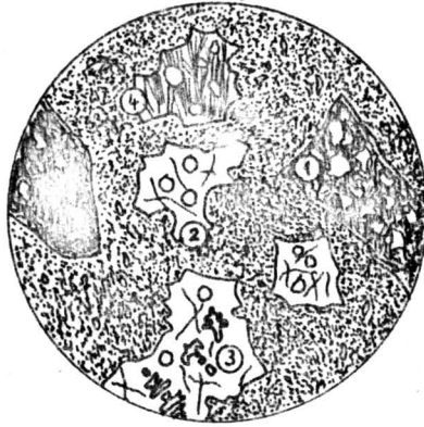
Fig. 81 - Beton cu agregate grele din produse ceramice neglazurate și din zgură de furnal B 250; 1- agregate din produse ceramice, 2- agregate din zgură de furnal cu structură vitroasă, 3- agregate din zgură de furnal cu \beta Ca 2 SiO 4 granular, 4- agregate din zgură cu \delta Ca 2 SiO 4 fibros N II, \approx 40 x .
