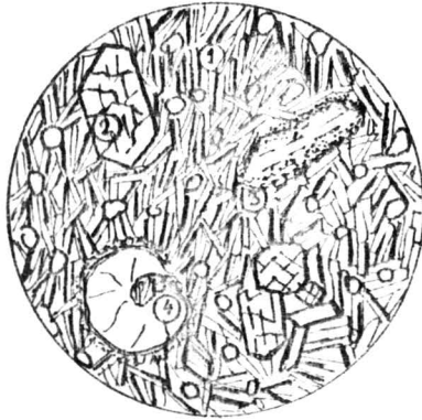
Fig. 89 - Andezit bazaltic de Malnaș: 1-pasta, 2-augit, 3-hornblendă bazaltică cu zonă marginală de opacit, 4-xenolit de cuarț corodat cu zonă de reacție; N +, ~ 40 x
