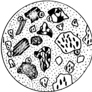
Fig. 65 - Mortar - 1-cuarțit, 2-liant, 3-feldspat plagioclaz, 4-calcar, 5-mică, 6-micro- clin; N +, ~ 40 x.
