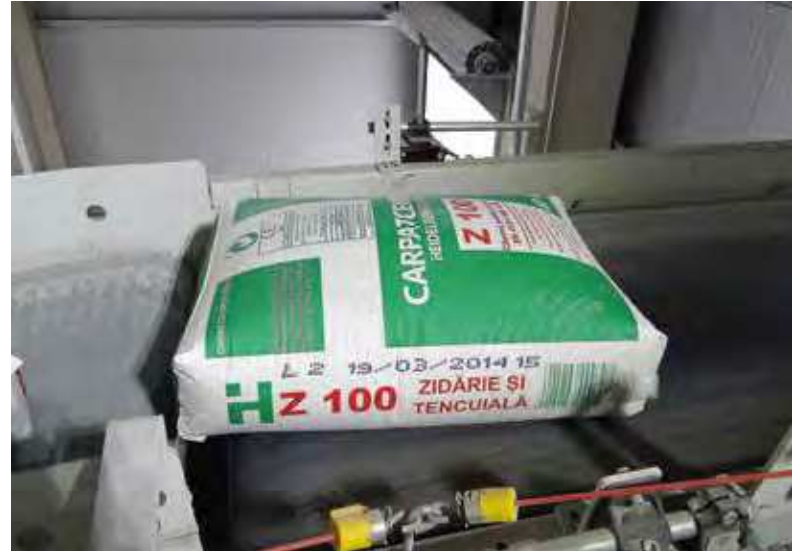
Banda alimentare instalație de paletizat
