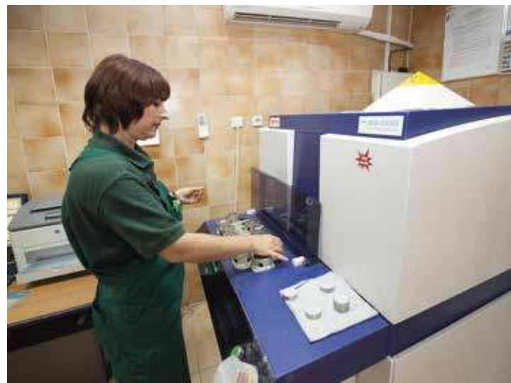
Laborator – pregătire probe-pastile pentru analizor
