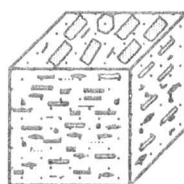
Structură anizotropă dată de orientarea particulelor
