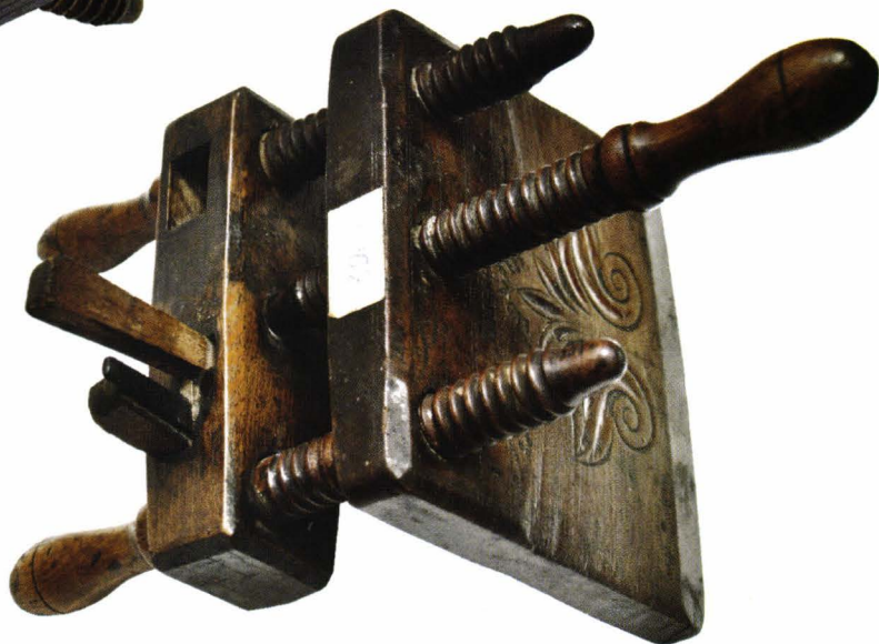
36. „Gardine” - rindele din lemn folosite pentru ulucul vasului, din Pâncota
