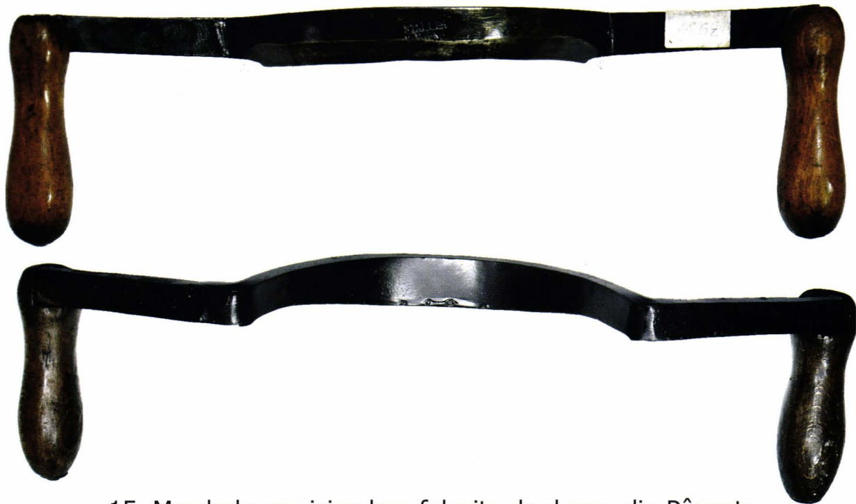
15. Mezdrele semicirculare folosite de dogar, din Pâncota
