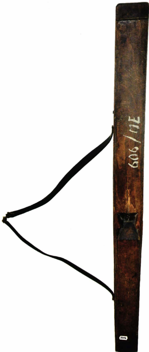
29. Rindea folosită de dogari care se deplasau pentru reparatul butoaielor ("holoangări")
