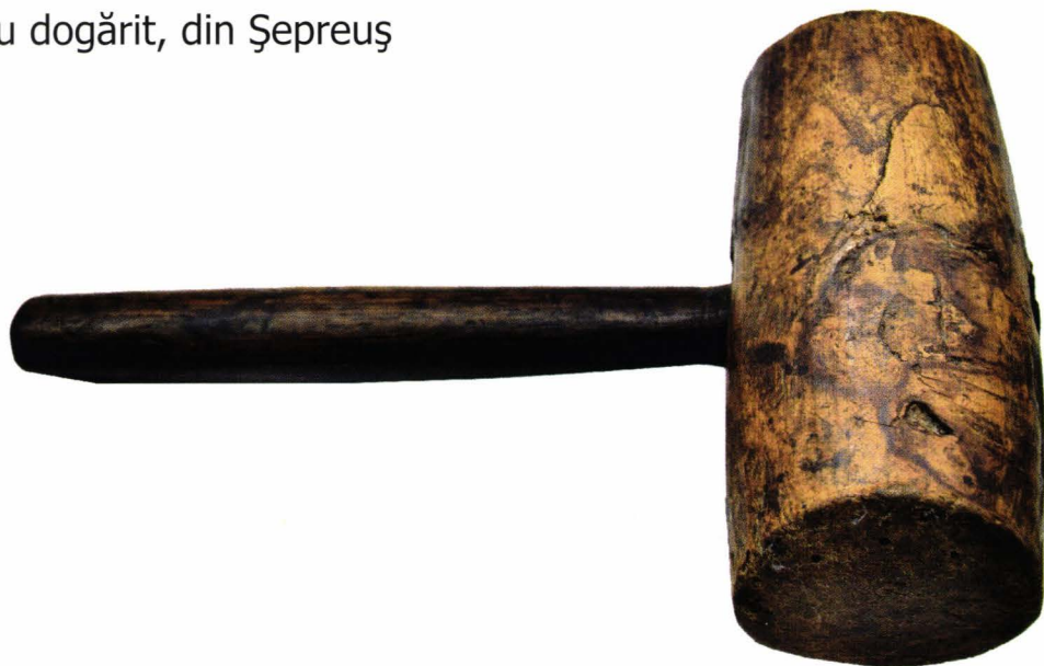
20. Ciocan din lemn pentru dogărit, din Șepreuş, folosit pentru bătutul cercurilor
