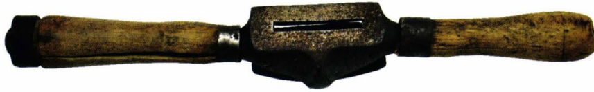
40. „Floritor” - rindea care se folosește pentru finisarea părții exterioare a butoiului
