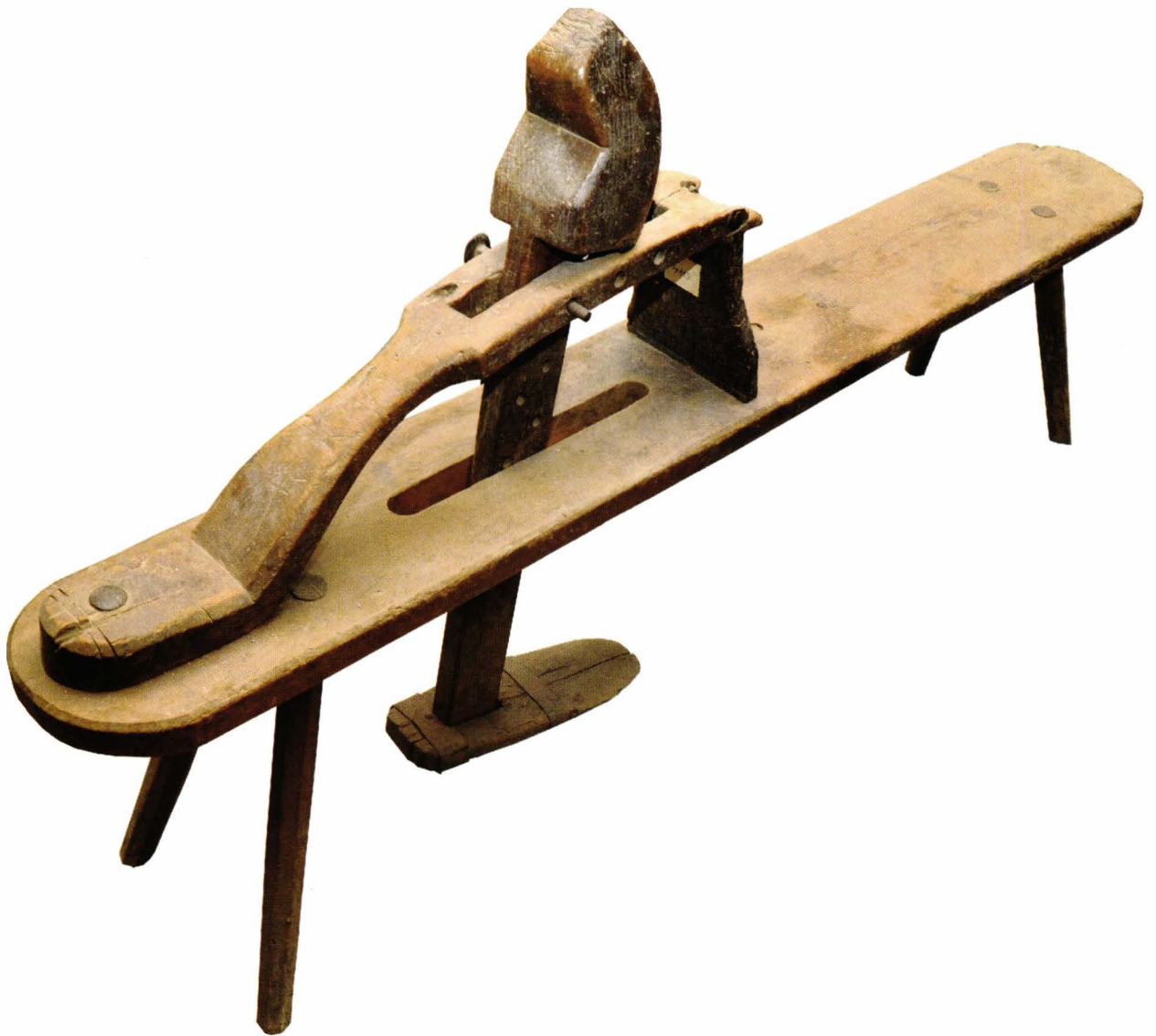
14. Scaun de dogărit - dispozitiv pentru prins doaga, din Șepreuș
