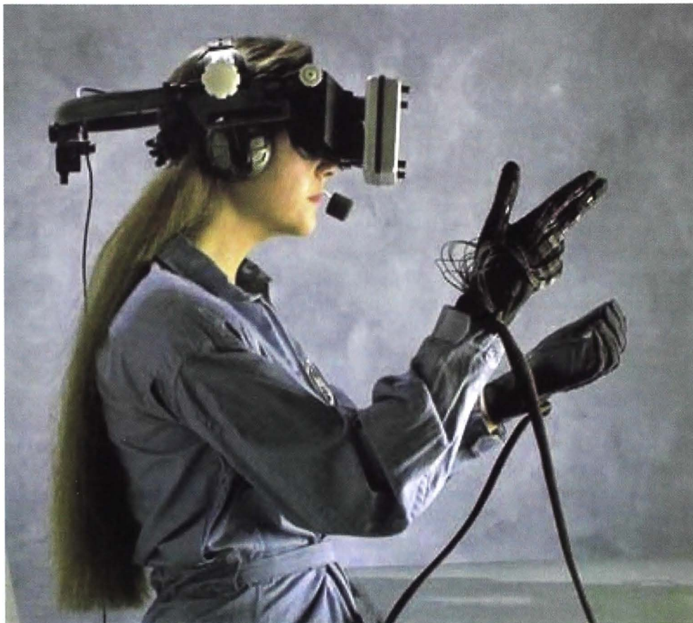
Fig 10. Exemple de căști de vizualizare portată / Exemple de casque de visualisation porté.
