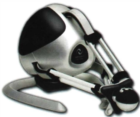
Fig 11. Mouse 3D cu retur de forță / Souris 3D à retour de force.
