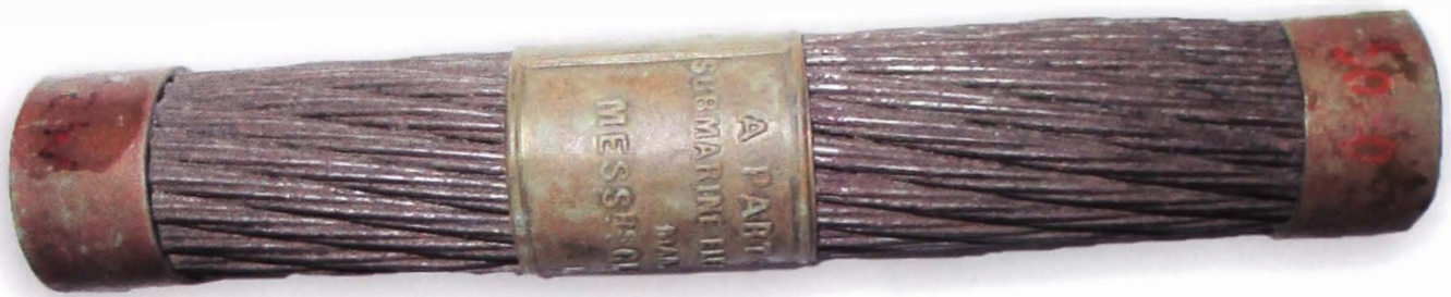
Cablu telegrafic submarin fabricat de firma londoneză Glass-Elliott. A doua jumătate a sec. XIX / Câble télégraphique sous-marin de l'entreprise londonienne Glass-Elliott. 2e moitié du XIXe s.
