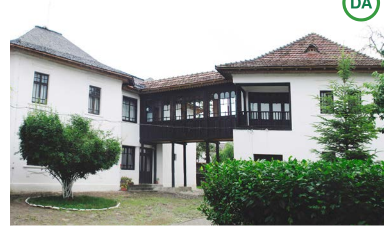
ASA DA: Exemplu de corp de legătură între două clădiri. Corpul de legătură poate fi doar la parter sau, ca în acest caz, doar la etaj. De asemenea, exemplul de față prezintă zone vitrate cu ochiuri tradiționale de geam.
