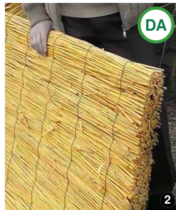
ASA DA: Exemple de pereți plăcați cu panouri termoizolante de stuf.
