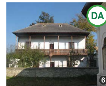
AȘA DA: Prispa poate fi realizată pe două niveluri, înglobând fie spații de trecere (tranziție), fie balcoane.
