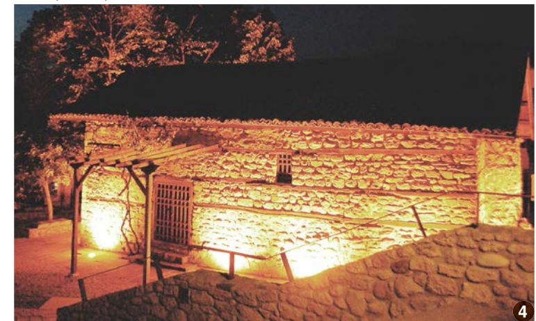
AȘA DA: Exemplu de iluminat pe timp de noapte a clădirilor importante folosind spoturi de pardoseală.
