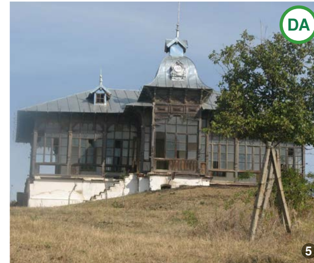
ASA DA: Exemplu de închidere a spațiului unei prispe de dimensiuni mai mari. Acest model de împărțire a folilor de geam este recomandat pentru scara firească pe care o creează chiar și atunci când este vorba de lungimi mari.
