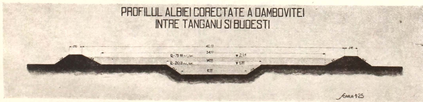
Fig. 98. — Profil transversal de regularizare.
