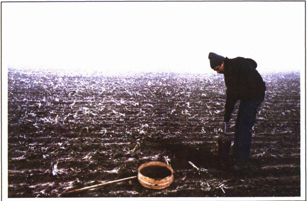
Figuur 7: Booronderzoek met de 20 cm Edelmanboor.
