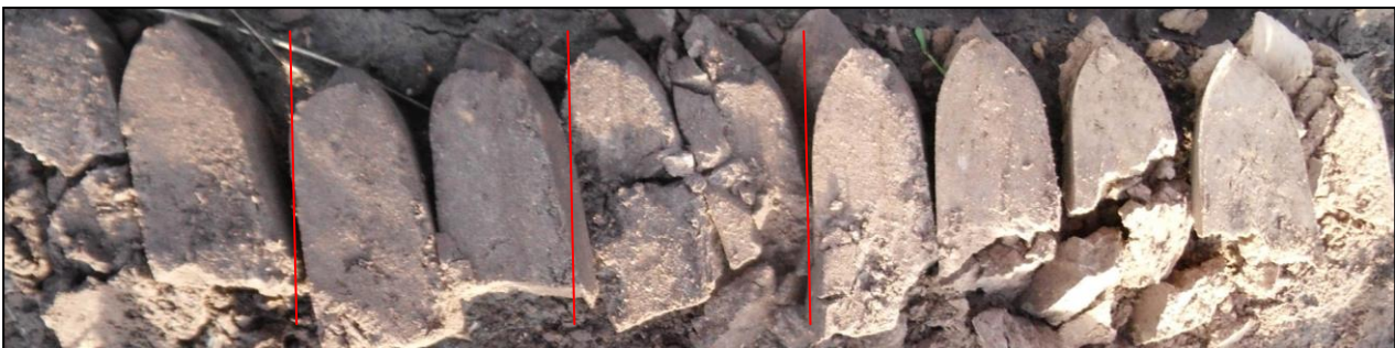
Figuur 7: boring 10 met in de top een recent ophoogpakket
