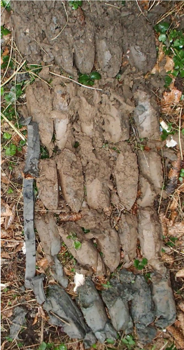
Boring 1: Boring in de dijk, boorkernen uitgelegd van rechts boven naar links onder.
