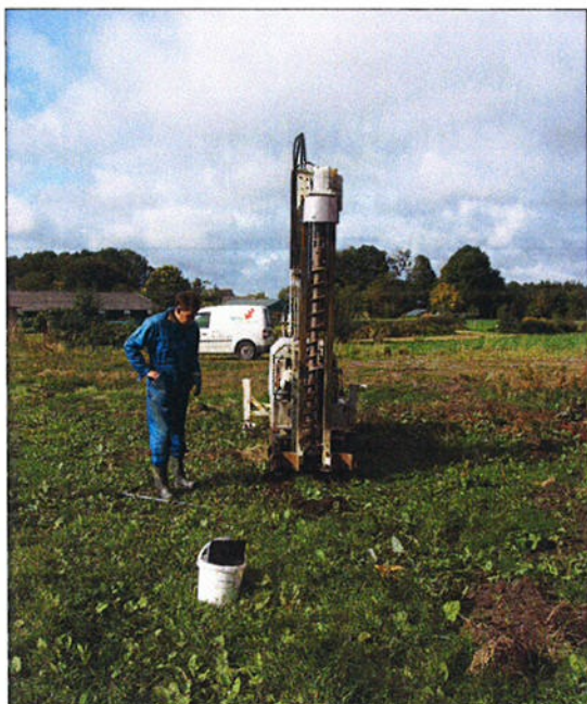
Afbeelding 3. De foto toont een avegaarboor, waarmee door puinlagen geboord kan worden.
