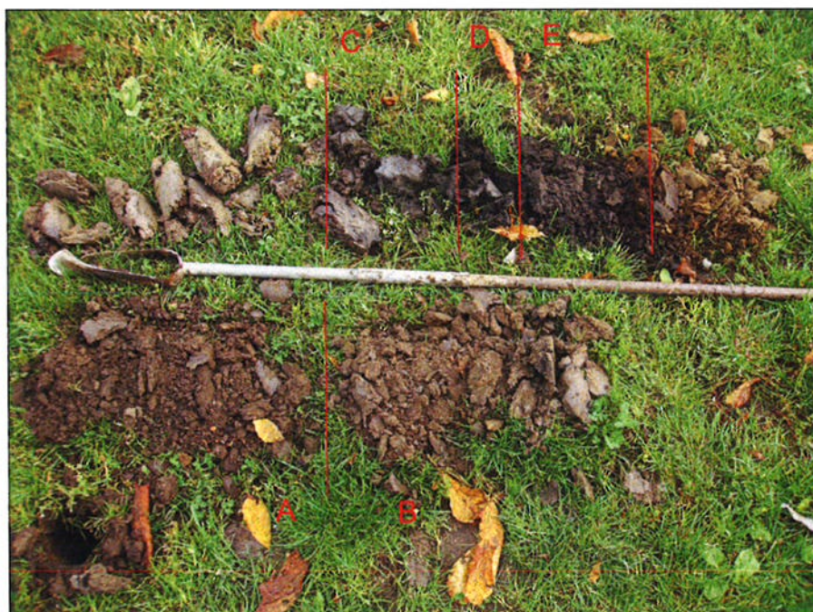
Afbeelding 2. Boring 1, waarbij van links naar rechts het volgende zichtbaar is: A: bouwvoor, B: klei met puinresten in de top, C: klei met verslagen veen, D: veenband, E: (podzol)bodemhorizonten in dekzand.
