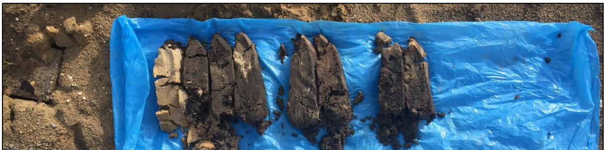
Figuur 6 Boring 2: 0-100 cm -Mv. Meerdere pogingen ondernomen de boring tot in de C-Horizont te zetten, echter steevast gestuit op een puinlaag op 70-100 cm -Mv.
