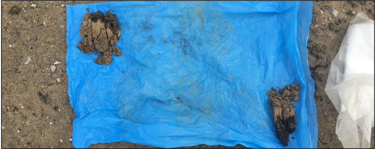
Figuur 5 Boring 1: 0-30 cm. Onder op het zeil ligt een tweede poging de boring te zetten. De boring is echter meermaals gestaakt in een betonlaag.
