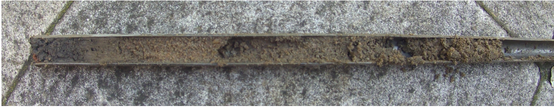
Figuur 8: Nieuwegein, Oude Sluis 16. Het opgebrachte zandpakket (rechts) met daaronder klei met daarin oranje baksteenpuin. Hieronder is ondoordringbaar materiaal aanwezig. Het lijkt om gebouwresten van oranje baksteenpuin te gaan.
