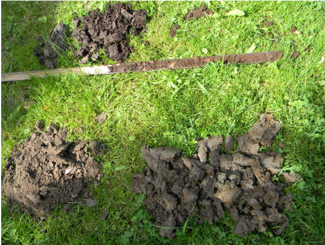
Opname van boring 1. In de guts is te zien dat het veen bovenin zwartbruin is en onderin wat lichter bruin.
