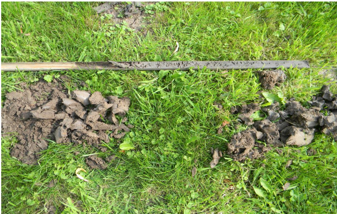
Opname van boring 6. In deze boring is tot een diepte van 2 meter –mv geen veen aangetroffen.
