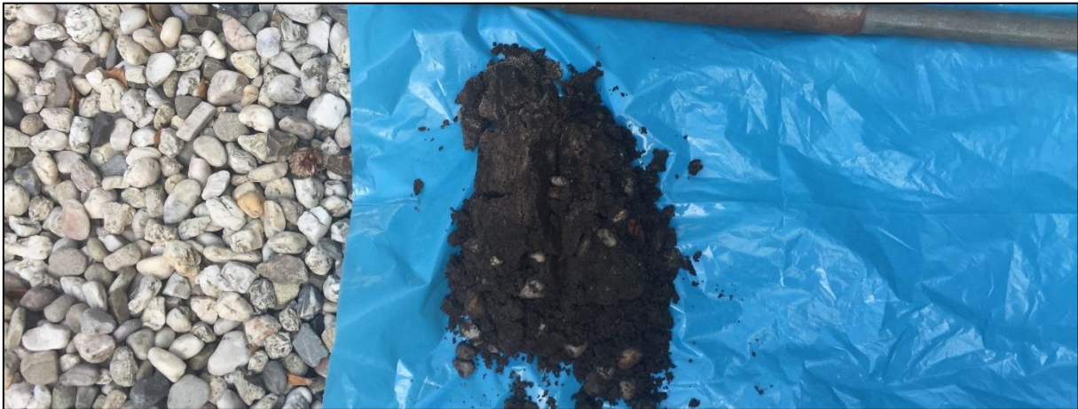
Boring 2: 0-30 cm -Mv. Meermaals gestaakt in het saneringspakket van een Huisbrandolietank, op een diepte van maximaal 50 cm -Mv.
