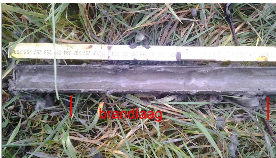
Figuur 3.3 Foto van een gutssteek van de bodemopbouw ter plekke van boring 6 op een diepte van 2,7 tot 3 m –mv (d.d. 23-12-2013). Tussen 2,7 en 2,95 cm –mv komt een relatief dikke kleilaag voor in veelal zandige afzettingen. In deze kleilaag zijn veel houtskoolspikkels in donkergrijze banden aangetroffen.
