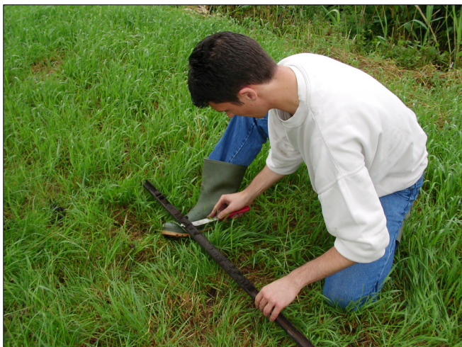
Figuur 1 , Doorsnijden van een boorkern in een 3cm -guts.
