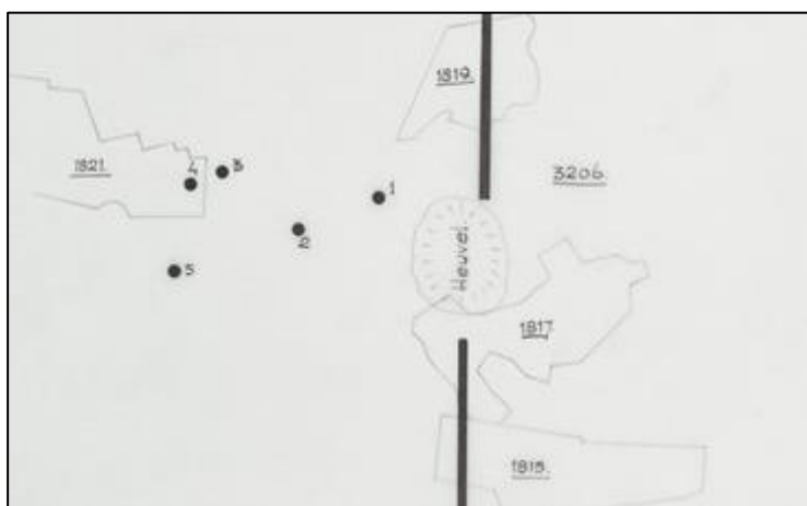
Figuur 10: Uitsnede van een tekening van het Bureau Registratie Verdedigingswerken uit 1956. Hierop is te zien dat ten westen van de heuvel met de onderbreking in de tankmuur diverse ondergewerkte en met zand gevulde woonschuilplaatsen (nrs. 1, 4 en 5) en waterbergplaatsen (nrs. 2 en 3) gelegen waren (bron: zandvoortsebunkerploeg.nl).
