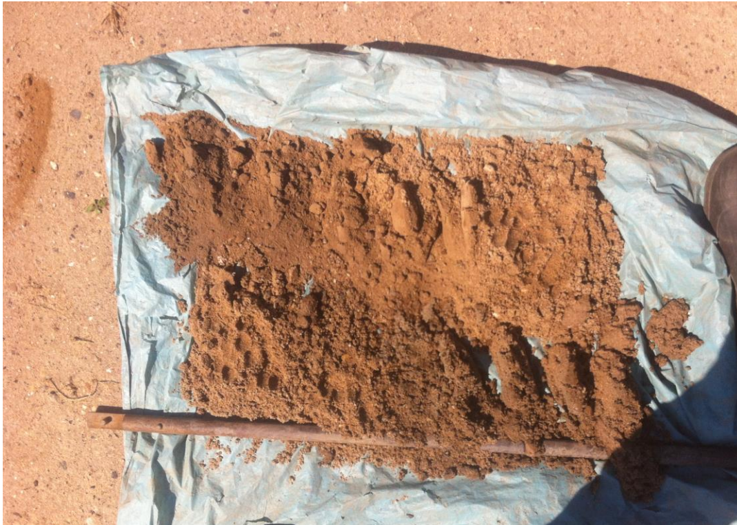
Boring 3; opname van de eerste 2,0 m –Mv.
