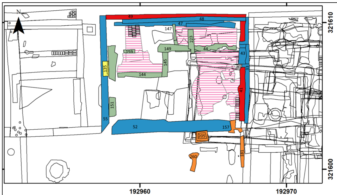
Afbeelding 48. De ligging van Structuur 6 geprojecteerd op een uitsnede van de sporenkaart met de bij de structuur horende funderingen (blauw, rood, groen, geel en oranje gemarkeerd en genummerd) en de vloeren (roze gearceerd). Schaal 1: 150.
