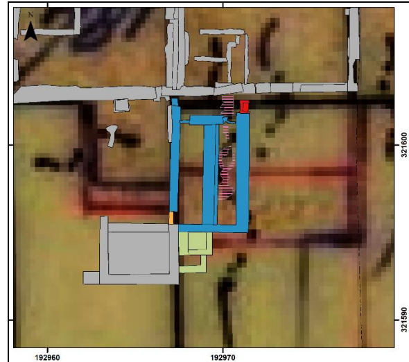
Afbeelding 78 (links). De ligging van Structuur 12 met de bij de structuur horende funderingen (blauw, groen, oranje en rood gemarkeerd), vloeren (roze gearceerd) en de destijds aanwezige structuren (grijs gemarkeerd), geprojecteerd op een uitsnede van de Kadastrale Hulpkaart uit 1875. Schaal 1: 300.
