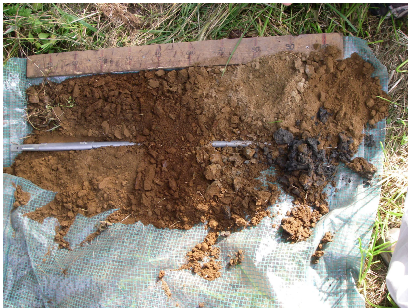
Fig. 3.3: Geulvulling (donkergrijs) onderin boring 1.
