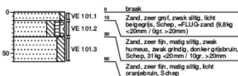
Figuur 17: Boorprofielen van milieukundig booronderzoek, deel 2 (Janssen 2018).
