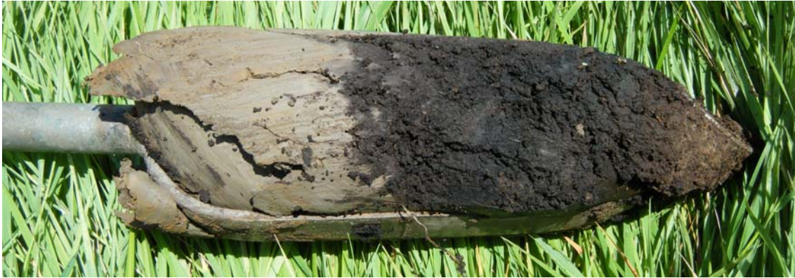
Afbeelding 3.3 Overgang klei op veen op leem in boring 33 (foto Grontmij).
