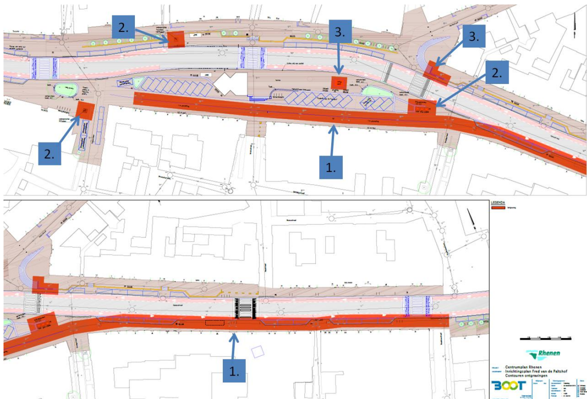
Afbeelding 1 Inrichtingsplan met locatie ingrepen. 1. = vervanging riolering. 2. = ondergrondse afvalcontainer. 3. = serviceput fontein. 4. Fundering keermuur. Bron: Gemeente Rhenen.
