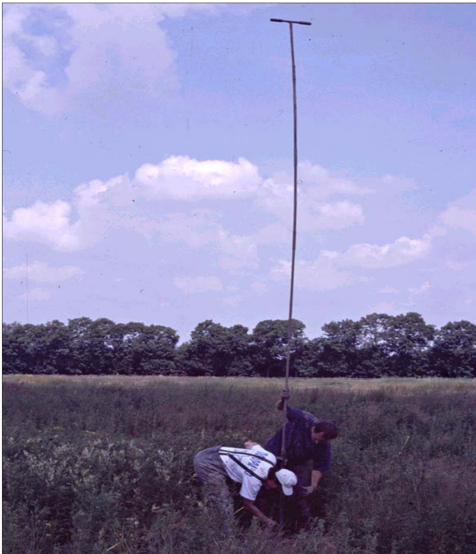
Figuur 2. Het boren tot 6 m -Mv in de praktijk.
