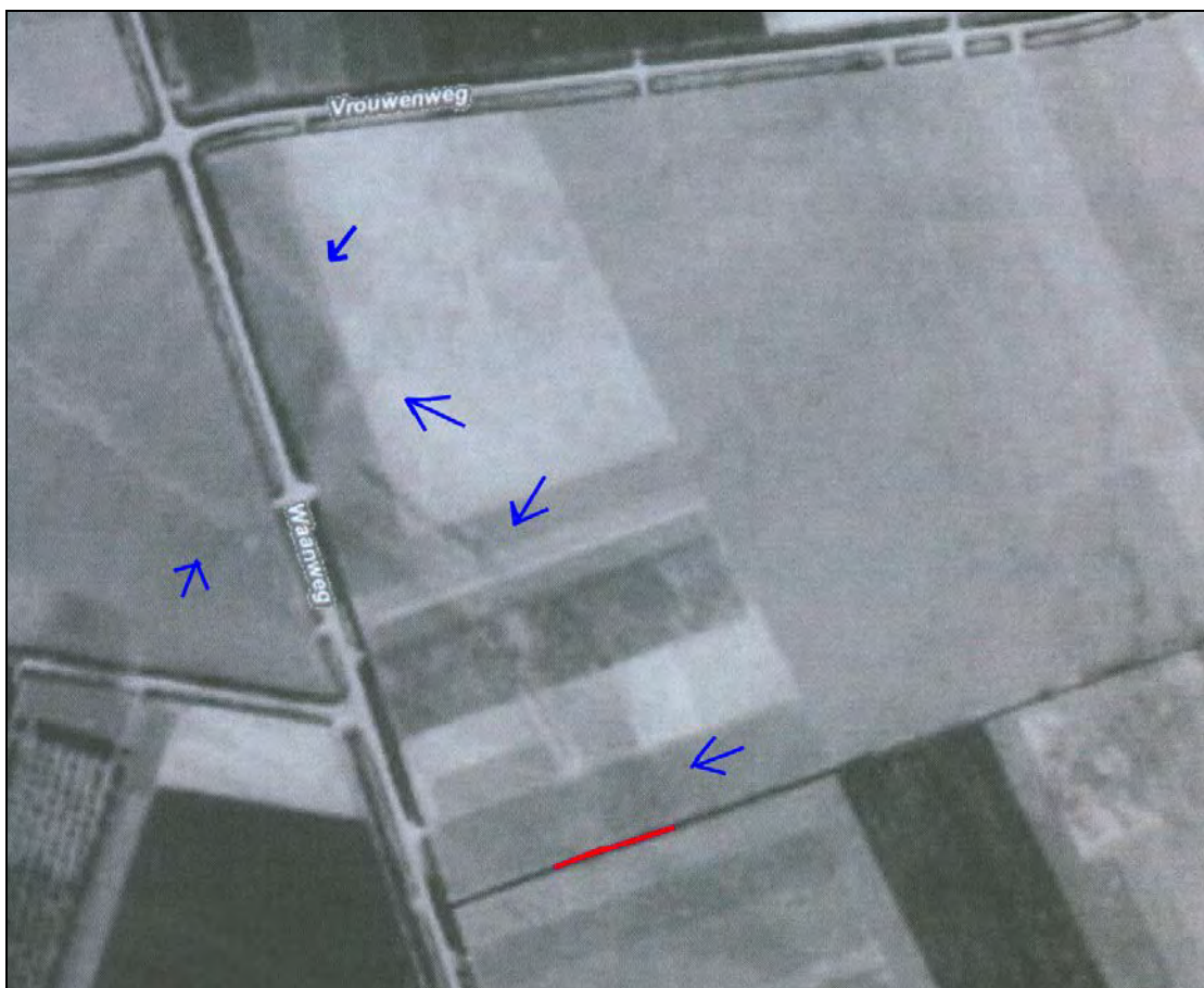
Afbeelding 10. Locatie C, Boring 37 t/m 39 (rood gemarkeerd), geprojecteerd op een luchtfoto uit 1959. Op de foto zijn de in de ondergrond aanwezige restanten van de oude wegen ('t Vrouwe Weegje en de Waanweg) met bermsloten zichtbaar (gemarkeerd met blauwe pijltjes). Ten noorden en ten zuiden van Locatie C splitst deze weg zich. Bron: Van Wilgen, 2013.
