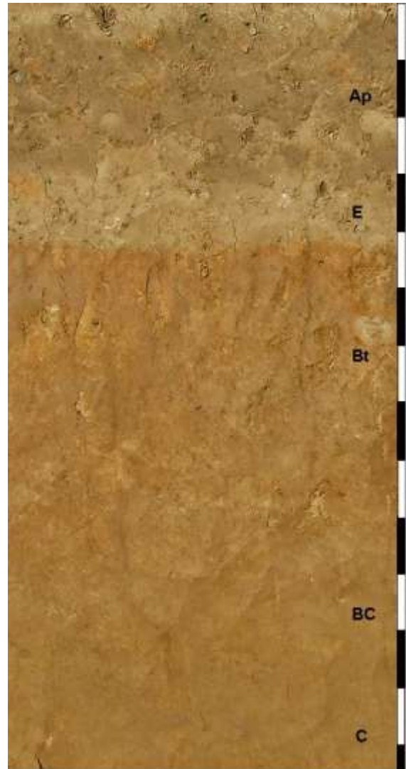
Figuur 9: Voorbeeld van een radebrikgrond onder bouwland in löss bij St. Geertruid. N 50°77' 22" / E 005°44'36". (foto: R. Paulussen).
